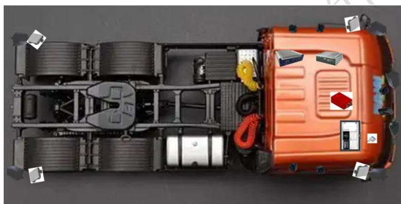
图 2-6 国内某商用车企业智能车数据采集传感器布置
