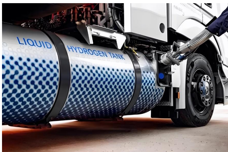
图12 典型液氢加氢枪与液氢加氢口连接示例图
