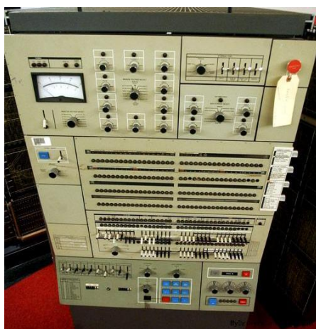
图 8 全球首台冷水冷却计算机 System360
