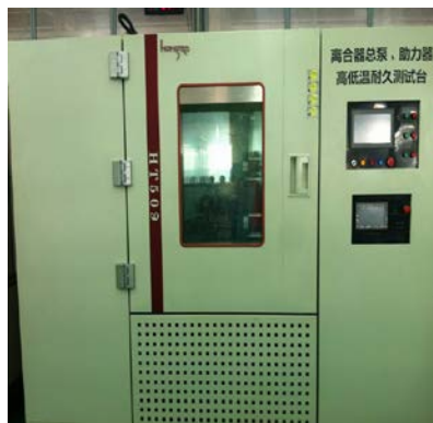
图8 离合器分泵耐久测试台
