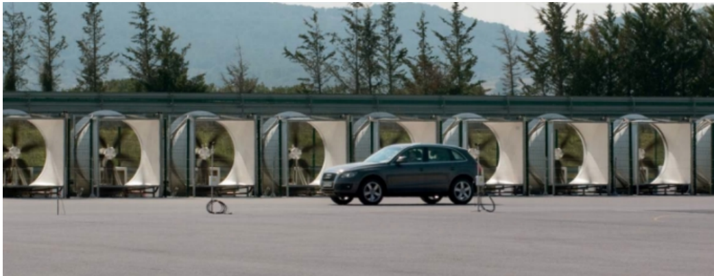
图 1 侧风响应道路试验设施
