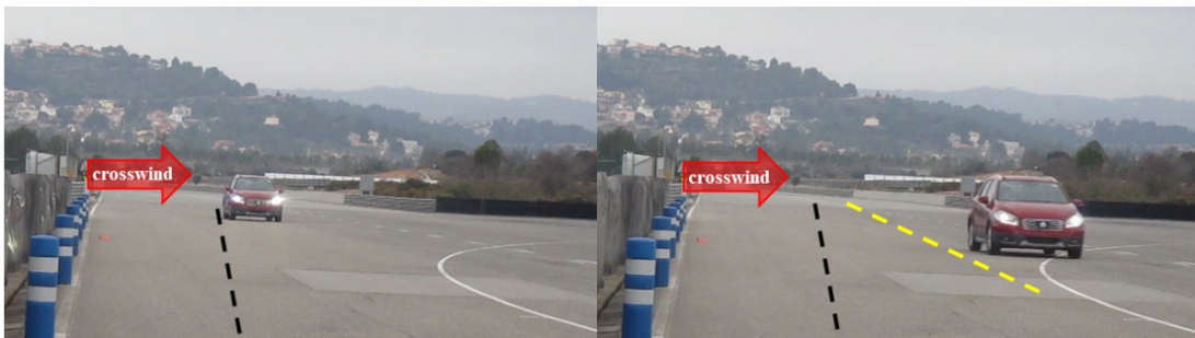
图 2 实车侧风响应测试示意图
