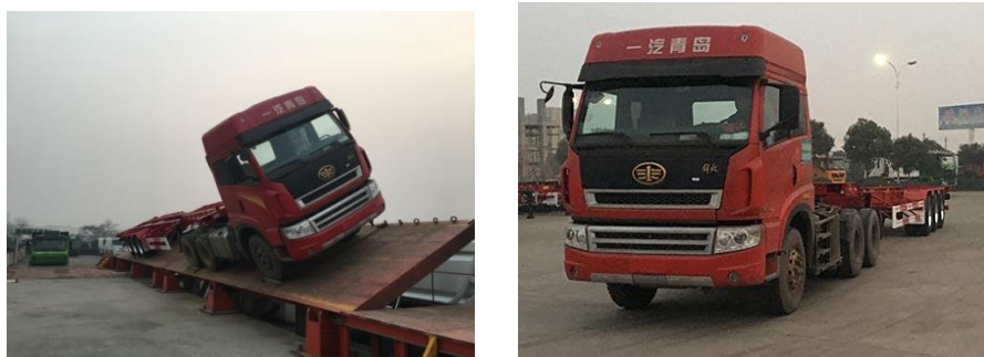
图 6 ZCZ9407TJZH 半挂车侧防护、后防护、侧翻试验
