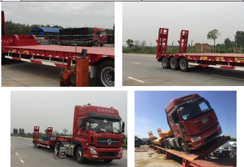
图 8 ZCZ9370TDPJ 半挂车侧防护、制动响应时间、侧翻试验
