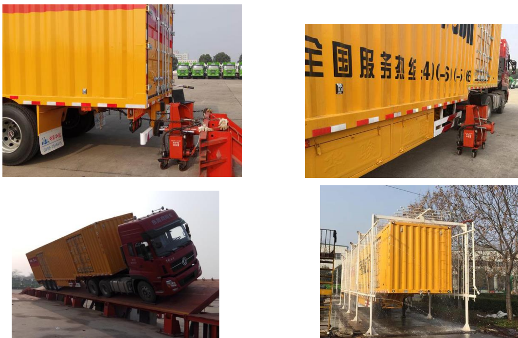
图 7 ZCZ9401XXYH 半挂车后防护、侧防护、侧翻、淋雨试验
