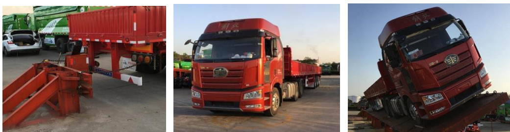
图9 ZCZ9401HJG 半挂车后防护、侧翻试验
