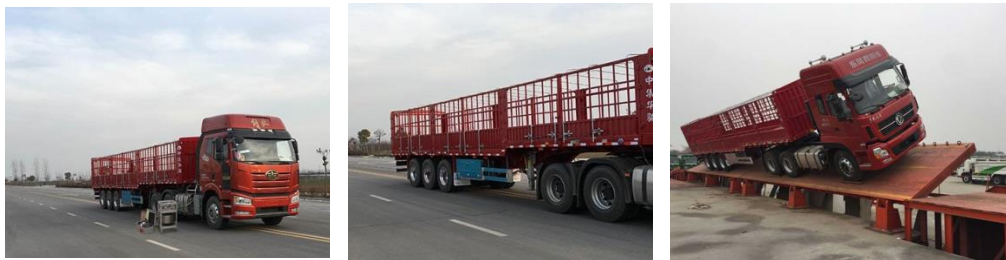
图 5 ZCZ9401CCYHJG 半挂车制动响应时间、侧翻试验
