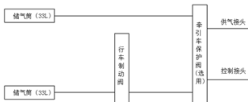
图 2 半挂车制动试验装置原理示意图
