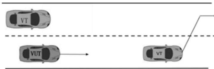
图23 前方车辆切出试验场景示意图
