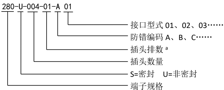
图 1 设备连接器（插头）的型式命名规则
