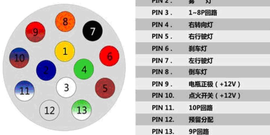
图 2 电连接器引脚定义
