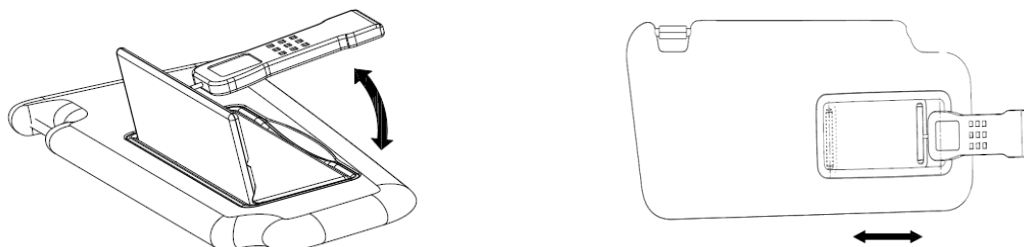
图8 化妆镜盖操作力测试
