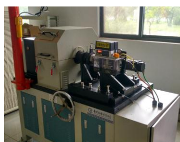
图 10 离合器分离轴承台架模拟机
