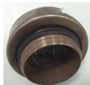
图 8 86CL6089F0H 轴承试后照片
