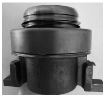
图 4 86CL6698F0 轴承试后照片
