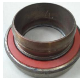
图 2 86CL6395F0T 轴承试后照片
