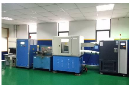
图 9 离合器分离轴承试验机
