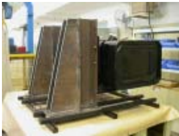
图 4. 金属燃油箱的振动试验
