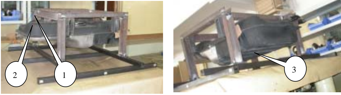
图8 A 试件上布置加速度传感器的3个位置点
